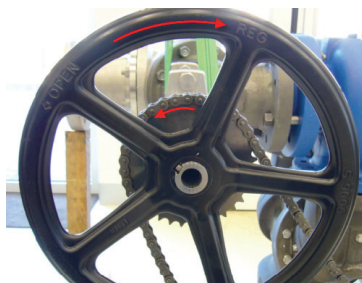
Kierunek obrotu pokrętła i koła łańcuchowego (Łańcuch jest zakładany podczas montażu). Por. krok 2 sposobu postępowania.
